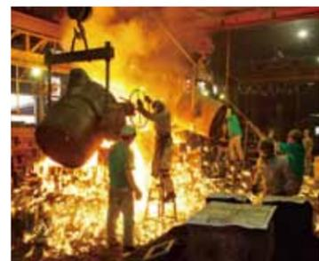
溶かした鉄を流し込む「注湯」
